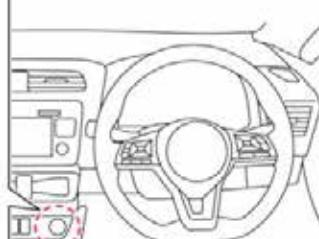
※ブレーキペダルを踏まずにパワースイッチを押したときは、走行可能表示灯は点灯せずにOFF⇒アクセサリー⇒ON⇒OFFの順番にモードが切り替わります。
